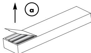
b) Retirez éventuellement les piles usagées et insérez correctement les piles neuves comme indiqué sur le schéma dans le compartiment des piles.
