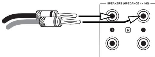
Si on utilise des câbles avec cosse, il faudra desserrer la molette de fixation en la tournant dans le sens antihoraire, insérer la cosse sous la molette et resserrer celle-ci en la tournant dans le sens horaire. Pour éviter tout dommage, assurez-vous que le branchement est bien serré et qu'aucune partie métallique dénudée de la cosse ne soit en contact avec la paroi arrière ou une autre borne de raccordement.
