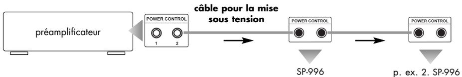
Un appareil émetteur peut théoriquement transmettre des impulsions de commutation à un nombre infini d'appareils. Sur la plupart des appareils, on peut utiliser pour cela une des deux prises « POWER CONTROL » comme entrée du signal d'impulsion et l'autre comme sortie. Cette méthode, consistant à mettre en circuit les entrées et les sorties des appareils et de les enchaîner ainsi, est aussi appelée « daisy chaining ».
