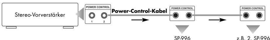
Durch ein sendendes Gerät können theoretisch unendlich viele Geräte mit den Schaltimpulsen versorgt werden. Zu diesem Zweck kann an den meisten Geräten einer der beiden „POWER CONTROL“-Anschlüsse als Signaleingang und der andere als Signalausgang verwendet werden. Diese Methode, das Signal durch Ein- und Ausgänge der Geräte durchzuschleifen und diese somit zu verketteten, wird auch als „daisy chaining“ bezeichnet.
