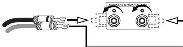
En l'absence de cosse, retirez l'isolant de chaque extrémité du câble sur une longueur d'un cm environ. Torsadez le câble dénudé, pour éviter les court-circuits, desserrez la molette de fixation en la tournant dans le sens antihoraire et insérez l'extrémité du câble dans le perçage dégagé du bornier. Serrez maintenant le câble en faisant tourner la molette de serrage dans le sens horaire. Contrôlez le serrage correct du câble.
