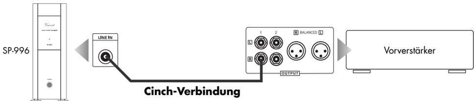
Wurde das Gerät mit dem Taster „POWER“ eingeschaltet, ist kein Power-Control-Kabel eingesteckt und ist der Umschalter „AUTO“ (5) auf „ON“ eingestellt, so wird das Gerät in Bereitschaft geschaltet, wenn an diesem Eingang für mehr als 30 Minuten kein Signal anliegt.
