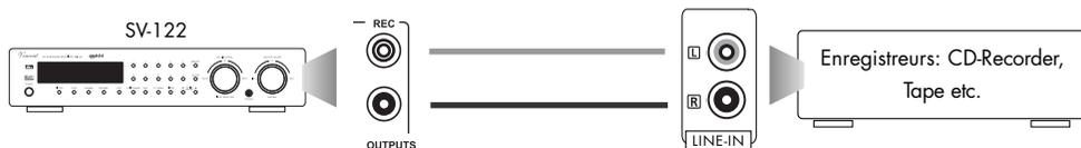
Vous pouvez aussi raccorder d'autres appareils, qui doivent être alimentés avec le signal de niveau Line à l'étage d'entrée du canal d'entrée sélectionné.
