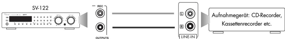
Verbinden Sie dazu diesen Signalausgang mittels Cinch-Kabel mit dem Signaleingang (RECORD oder INPUT) des Aufnahmegerätes.
