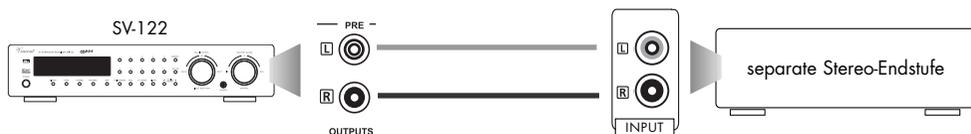
Dies kann sinnvoll sein, wenn neben einem kompakten Lautsprecherset für Mehrkanalton zwei höherwertige Lautsprecher für Stereo-Musikwiedergabe verwendet werden sollen. Diese Lautsprecher werden dann an die Endverstärkerausgänge angeschlossen.
