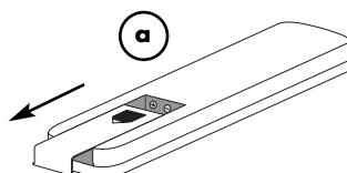
b) Retirez éventuellement les piles usagées et insérez correctement les piles neuves comme indiqué sur le schéma dans le compartiment des piles.
