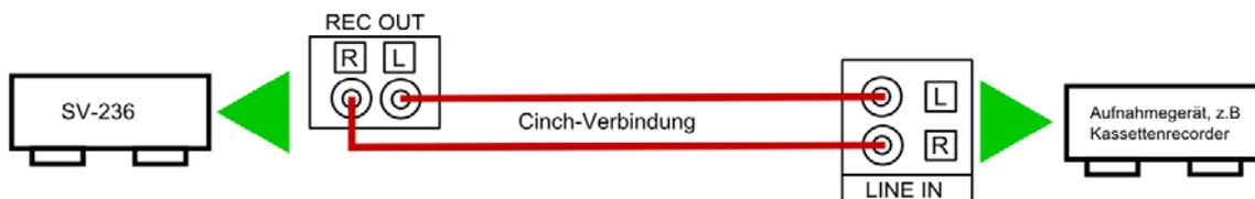
Verbinden Sie dazu diesen Signalausgang mittels Cinch-Kabel mit dem Signaleingang („LINE IN“, „TAPE IN“ oder „REC IN“) des Aufnahmegerätes. Verbinden Sie diesen Signalausgang mittels Cinch-Kabel mit dem Signaleingang („LINE IN“, „TAPE IN“ oder „REC IN“) des Aufnahmegerätes.
